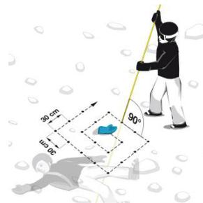
**HINWEIS** Die PIEPS iPROBE unterstützt in dieser Phase optimal durch eine optische und akustische Trefferanzeige im Nahbereich des Verschüttenden (<50cm).
