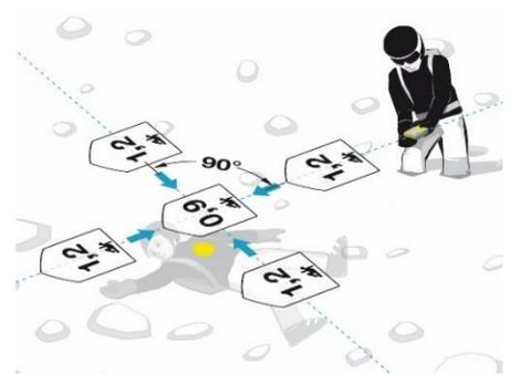
Machen Sie bei der Feinsuche keine schnellen Bewegungen, reduzieren Sie die Suchgeschwindigkeit auf 10 cm/s und vermeiden Sie Drehen/Schwenken! Suchen Sie entlang der Y-Achse bis zum Punkt der geringsten Entfernungsanzeige, suchen Sie dann entlang der X-Achse. Suchen Sie immer über den Punkt der geringsten Entfernungsanzeige hinaus um die Distanzanzeige zu verifizieren. Markieren Sie den Punkt der geringsten Entfernungsanzeige und beginnen Sie mit dem systematischen Sondieren.
